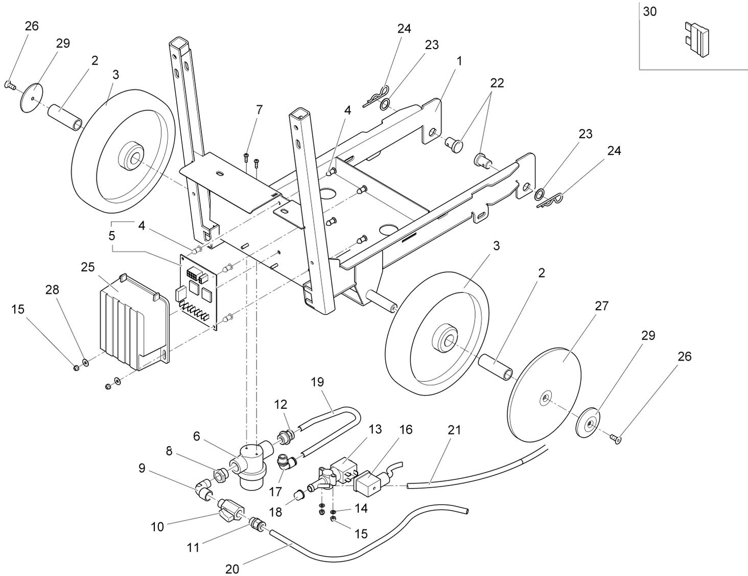
Fahrgestell/ Wasserzulauf / Chassis group/ Water feed system / Chassis/ Afflux d'eau
