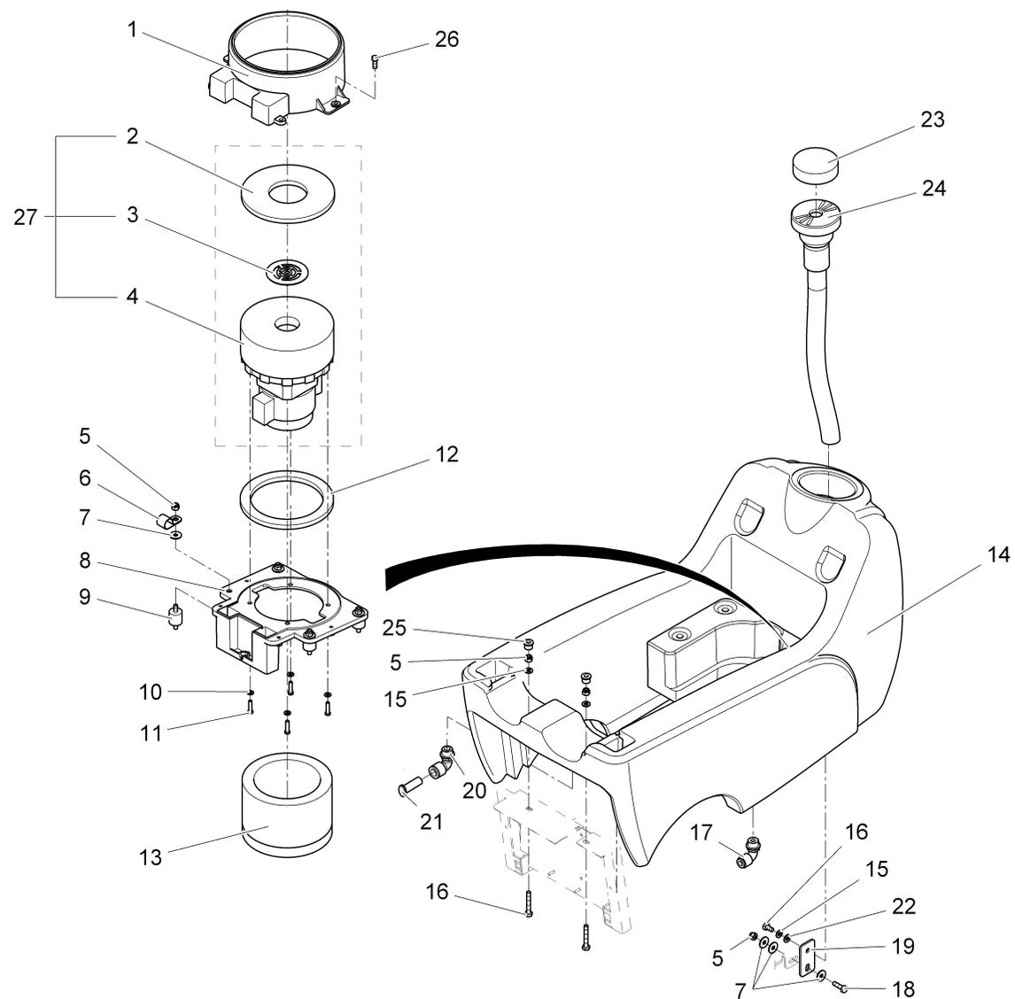
**Behälter/ Saugmotor / Hopper/ Suction motor / Réservoir/ Moteur d'aspiration**
