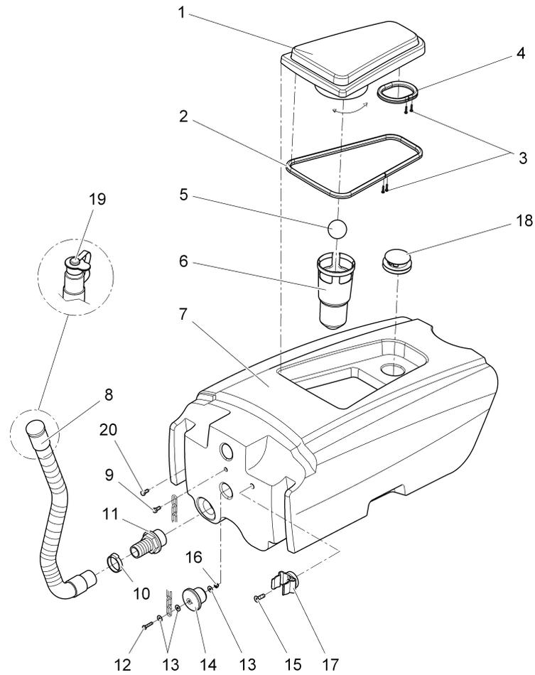
Schmutzwassertank / Drain water tank / Réservoir d'eau salé
