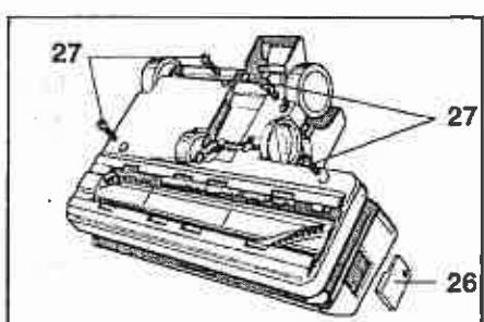
Zum Öffnen der Teppichbürste die Verschlußkappe (26) abschrauben. An der Unterseite nur die 4 großen Schrauben (27) lösen und dann das Oberteil abziehen.
