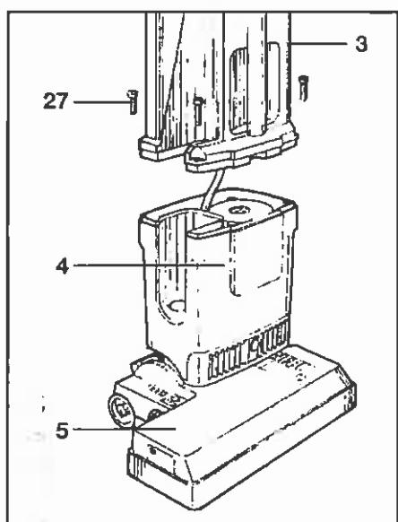
Zum Abnehmen des Filtergehäuses (3) vom Motorgehäuse (4) den Saugteil eingerastet auf der Teppichbürste (5) stehen lassen. Filterdeckel und Schlauch abnehmen, die 4 Schrauben (27) lösen und das Filtergehäuse vorsichtig vom Motorgehäuse abziehen.
