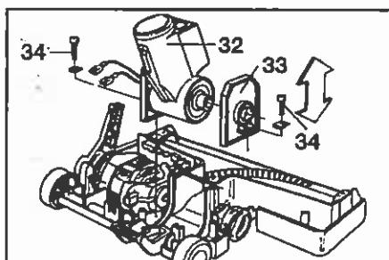
Zum Herausnehmen des Gelenkes (32) die beiden Schrauben (34) an den Gelenklagern (33) lösen und Gelenk mit Gelenklagern aus den Gehäuseschlitten ziehen.
